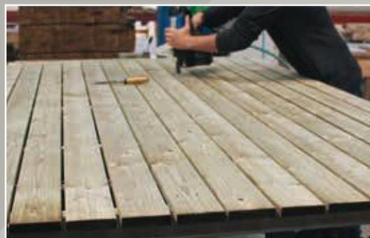
Poste fabrication planchers cloués inox ou galva
